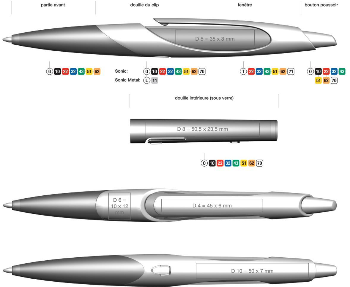
D 4 – sur le clip                      D 5 – sur la fenêtre extérieure, à gauche et à droite du clip                      D 6 – devant le clip
